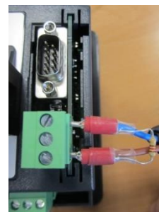
Extremo del cable del SCO10 remoto
